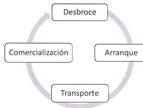
1. **Desbroce.** - Consistía en el retiro de la cobertura vegetal, que se encuentra en la parte superior del mineral, con la finalidad de facilitar su explotación, el material producto del desbroce será dispuesto en el depósito de topsoil.
